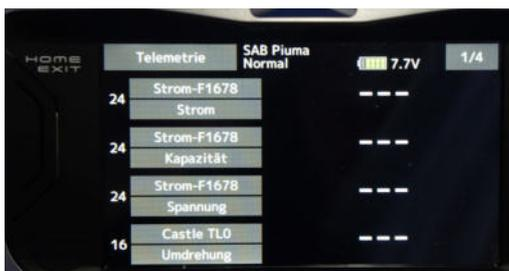
Die Einrichtung des Futaba Hot Key ermöglicht die direkte Anzeige aller Werte am Sender. Links ein Beispiel dazu. Sobald der Antriebsakku am ESC angeschlossen wird, werden anstelle von - - - die gemessenen Werte angezeigt. (ohne Abb.)
