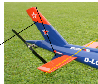
Optional anzubringender CFK Holm zur Versteifung der Seitenflosse
